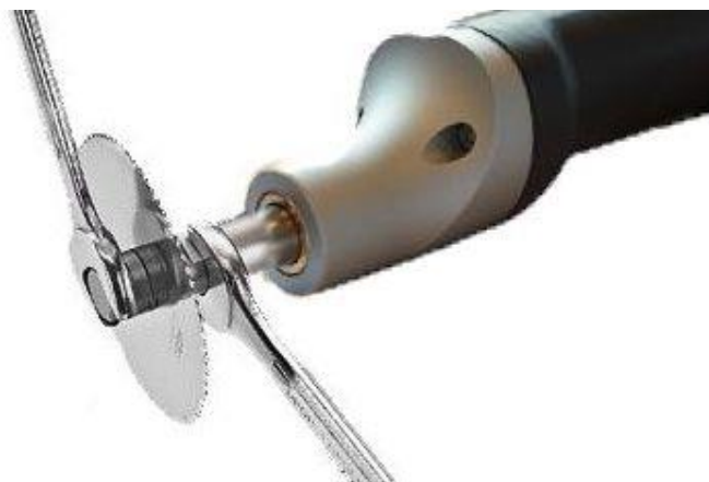
Abbildung 1: Lösen der Halteschraube
